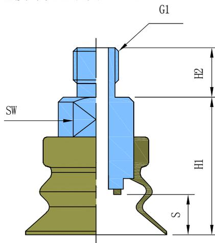
▶ 连接螺纹组装图(内螺纹)
